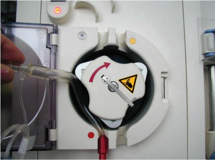
Segurar a mangueira por cima do segmento da bomba. Inserir o segmento da bomba na caixa da bomba, formando um arco.
