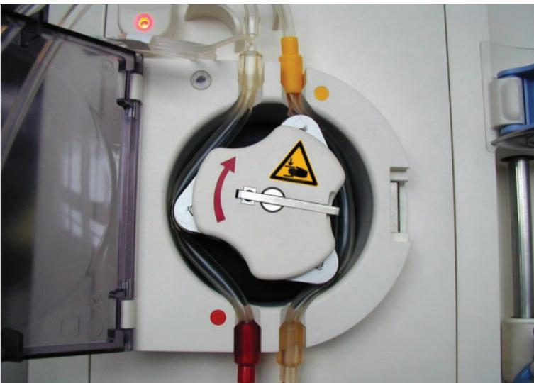
Inserir a extremidade inferior do segmento da bomba na bomba peristáltica.
