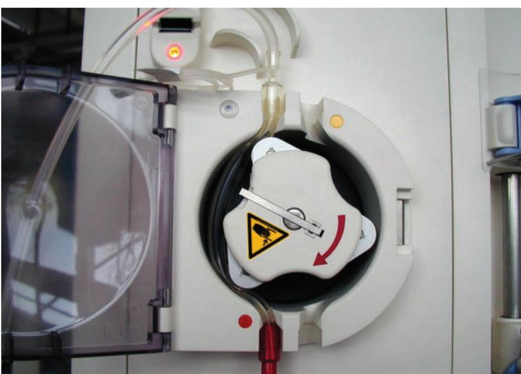
Inserir a extremidade superior do segmento da bomba na bomba peristáltica.
