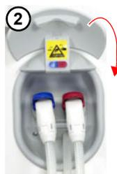
Abrir ou fechar a porta do Shunt Interlock (a figura mostra a atribuição de cores padrão):
